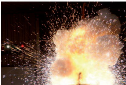
Arc flash 7 kA
